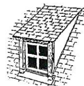
Lucarne rampante dite «chien couché»
