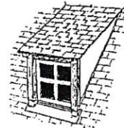
Lucarne rampante dite «chien couché»
